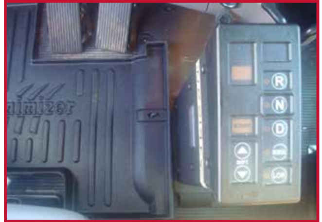
Figura 3 - Torre de control del Ultra Shift
