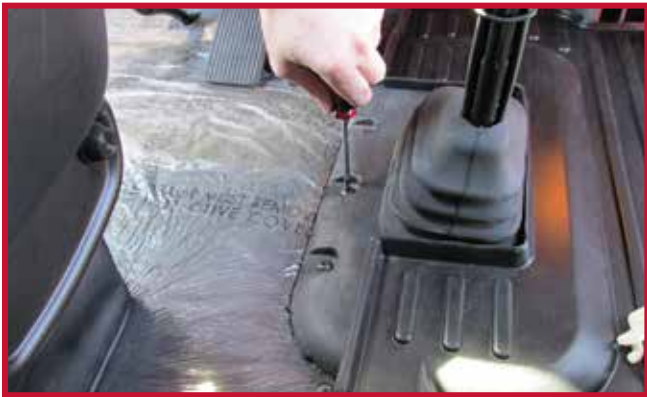
Figura 11 - Extracción del tornillo
