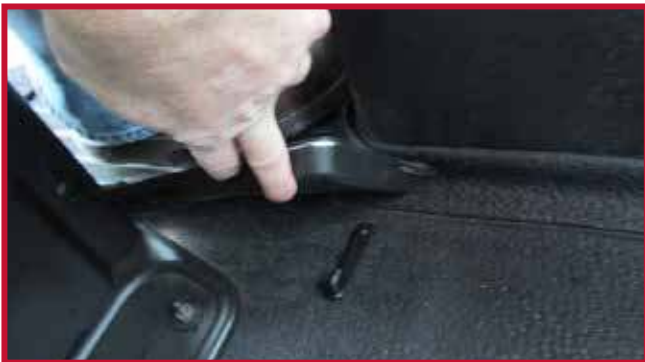
Figura 12 - Gancho correctamente instalado
