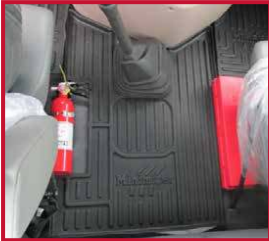
Figura 5 - Instalación del tapete central recortado
