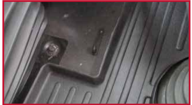
Figura 8 - Gancho de retención correctamente instalado
