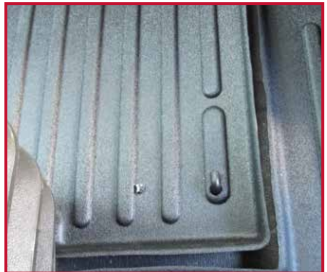
Figura 8 - Instalación del gancho del tapete del conductor
