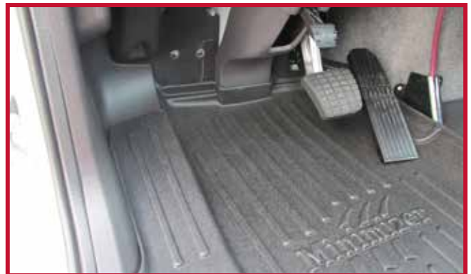
Figura 4 – Posición del tapete del conductor
