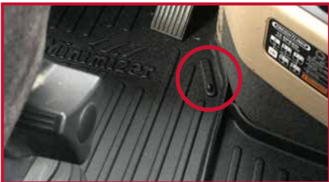
Figura 11 - Instalación del gancho del tapete del conductor
