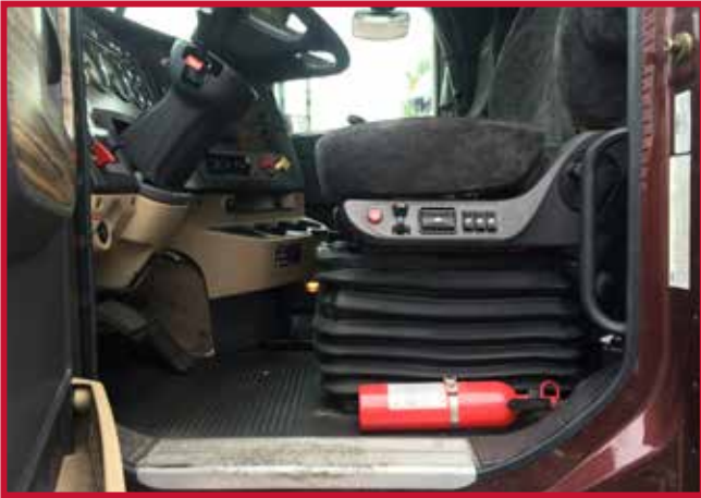
Figura 5 - Asiento del conductor con faldón de goma
