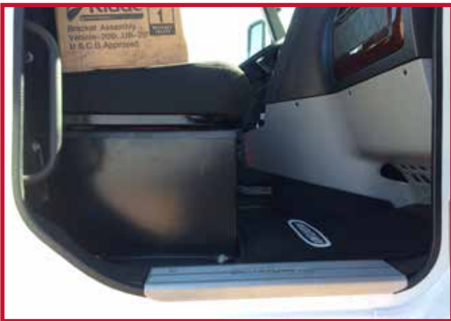
Figura 6 - Asiento del pasajero con caja de batería
