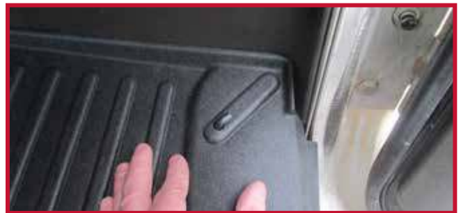
Figura 17 - Gancho del tapete del pasajero instalado
