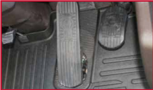
Figura 2 - Pedal de aceleración montado en el piso
