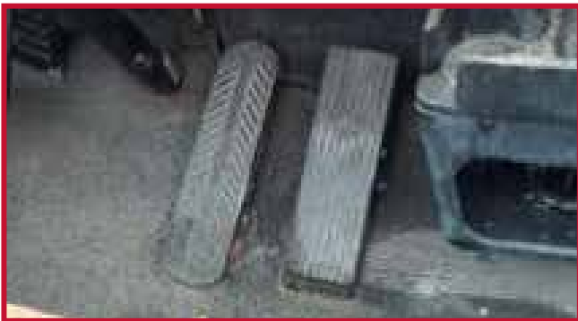
Figura 2 - Pedal de aceleración montado en el piso
