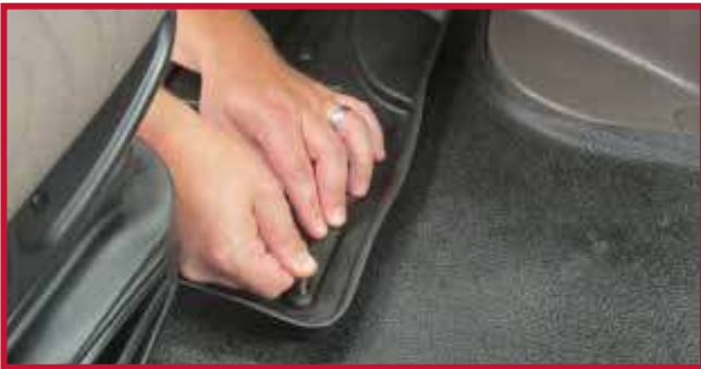
Figura 7 - Aplicar presión al gancho
