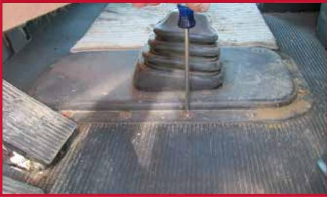
b) Localice el gancho de retención; el espaciador de poliéster y el tornillo de máquina de 1/4 "x 1.75"; se muestra en la figura 7. Inserte el tornillo a través del orificio del gancho de retención y coloque el espaciador de poliéster negro en el perno debajo del gancho.
