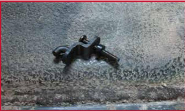
c) Introduzca el conjunto del gancho a través de la tapa de la transmisión y apriételo con un destornillador Phillips nº 3. Oriente el gancho del tapete para que apunte directamente hacia la palanca de cambios, como se muestra en la figura 8.
