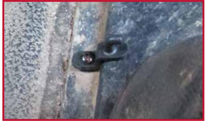
9. Instale el tapete del lado del conductor y engánchelo en el gancho de retención. El tapete del conductor debe empujarse completamente hacia delante para que el borde delantero haga pleno contacto con los paneles inferiores del salpicadero. Acomode el borde trasero izquierdo del tapete del pasajero sobre la parte superior del borde trasero derecho del tapete del conductor.
