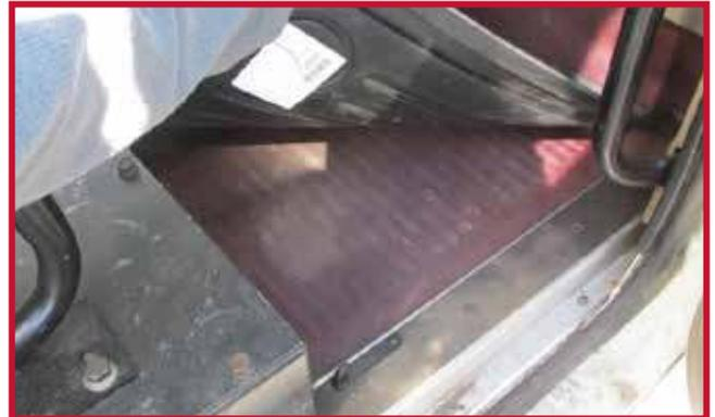
18. Confirme que el gancho de retención está completamente encajado en el tapete del conductor y que el gancho está adherido al piso. Si el gancho de retención del tapete del conductor no funciona correctamente o el tapete no puede instalarse de forma segura, no utilice un tapete Minimizer en el lado del conductor del vehículo.
