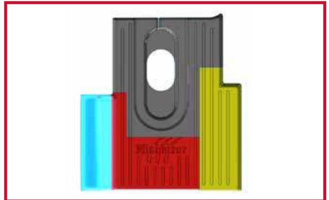
Nota: Algunos camiones más antiguos con transmisiones automáticas están equipados con una torre de control que se fija al piso como se muestra en la figura 8. Es necesario recortar a mano el tapete central para que sea compatible con las torres de control montadas en el piso.
