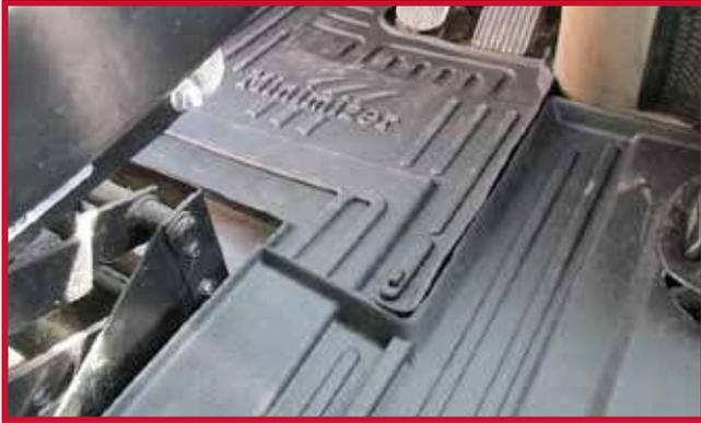
Marque la posición aproximada en la que debe fijarse el gancho al piso. Una vez localizada la posición, retire el tapete del conductor del camión.
