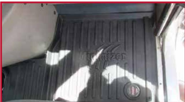
17. Utilice el mismo proceso indicado en los pasos 7-14 anteriores para fijar el gancho de retención del tapete del pasajero al piso. Siga los mismos pasos básicos para aplicar Primer 94 en la superficie y fijar el gancho al piso de la cabina como se muestra en la figura 11.
