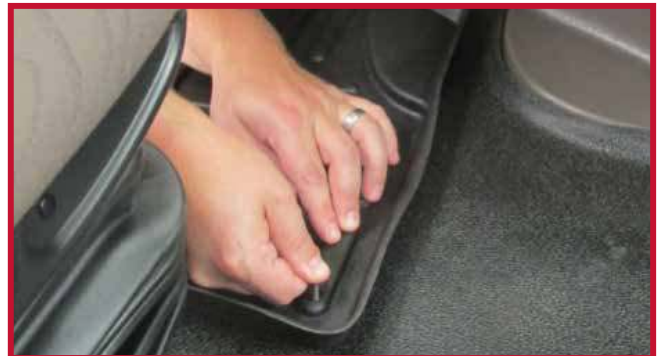
Figura 11 - Tapete y gancho del conductor correctamente instalados
