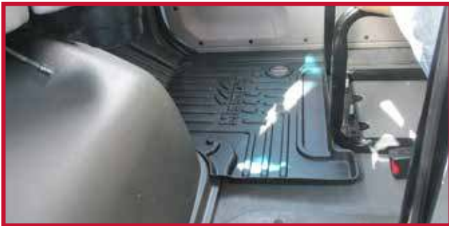
Figura 13 - Gancho del tapete del pasajero instalado en la moldura de la cabina
