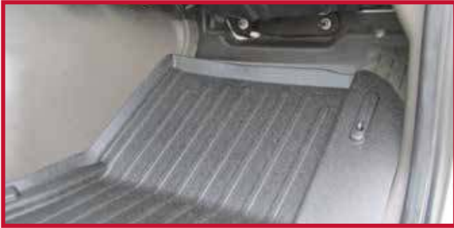
Figura 12 - Tapete y gancho del conductor correctamente instalados
