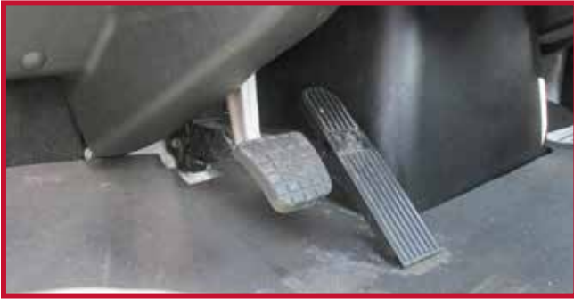
Figura 2 - Mecanismo del pedal del acelerador montado en el piso
