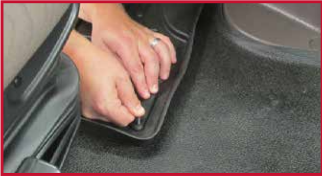
Figura 19 - Aplicar presión al gancho
