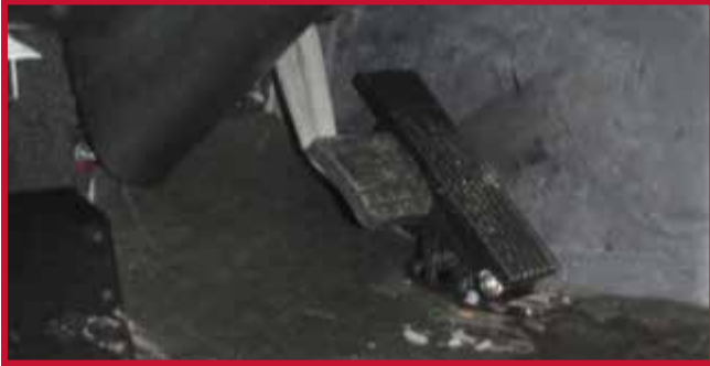
Figura 2 - Mecanismo del pedal del acelerador montado en el piso
