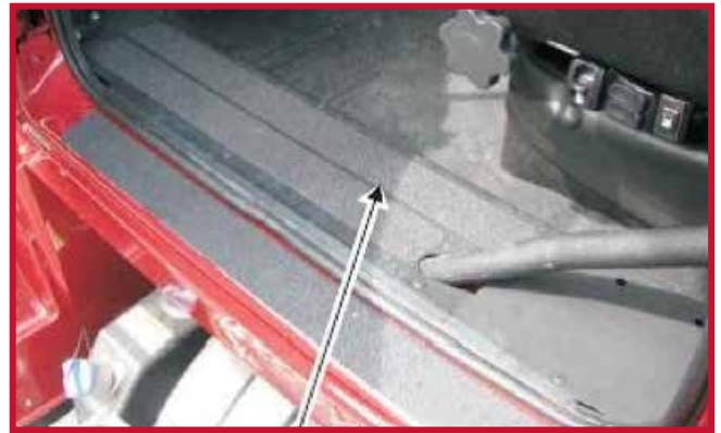
Figura 6 - Bandeja eléctrica del lado del conductor
