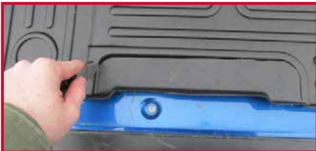
Figura 16 - Recorte manual del asiento con goma alrededor
