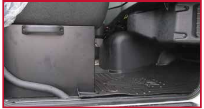
Figura 22 - Asiento del pasajero de base fija con tapete recortado
